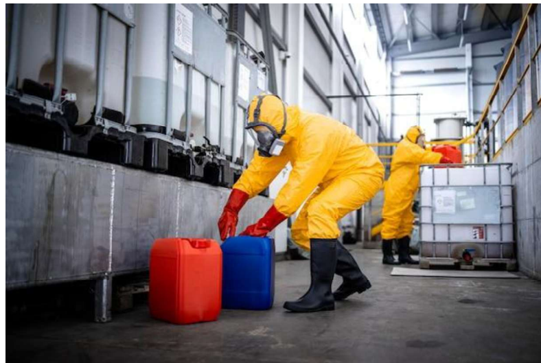
Figura 25: Trabalhador em planta de galvanização utilizando EPIs típicos (capacete, óculos, respirador, luvas químicas, avental, calçado de segurança, proteção auditiva).
