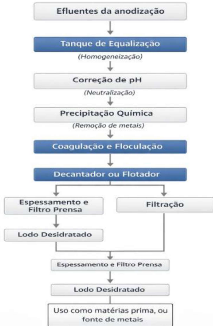
Figura 28: Exemplo de fluxograma com os passos gerais do tratamento de efluentes de anodização
