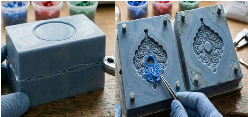
Figura 7 – Esquema de molde em silicone e cópia em cera para joalheria
