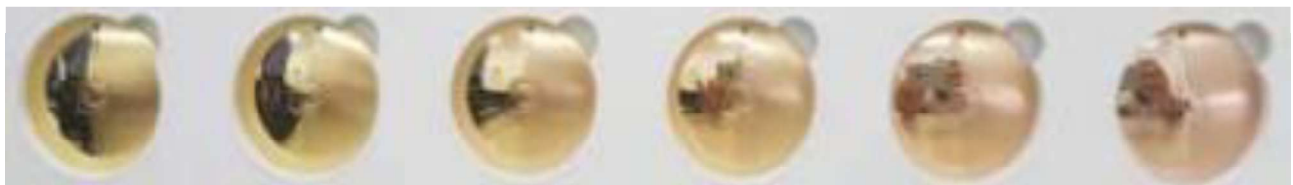
Figura 13: Exemplos de variação de cores em ligas de ouro (amarelo, rosê, vermelho).
