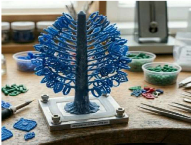
Figura 8: Representação esquemática de árvore de cera para fundição de joias.
