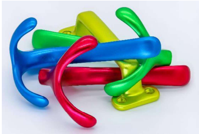
Figura 24: Aspecto superficial, evidenciando as várias cores obtidas pela anodização de alumínio, coloração e selagem
