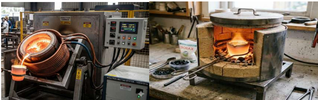
Figura 6 – Exemplos esquemáticos de fornos de fusão: indução e cadinho, respectivamente
