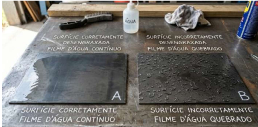
Figura 3 – Comparação entre superfície com falha de desengraxe (direita) e superfície corretamente desengraxada (esquerda), com formação de filme d'água uniforme
